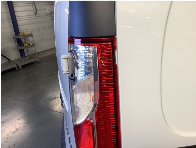
Feu ARD - Cassé - Remplacement
