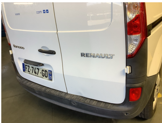
Porte ARD - Enfoncé - Forfait reparation
