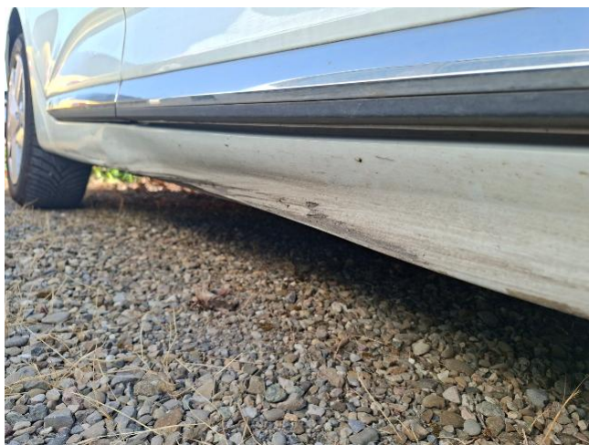
Bas de caisse D - Enfoncé - Remplacement
