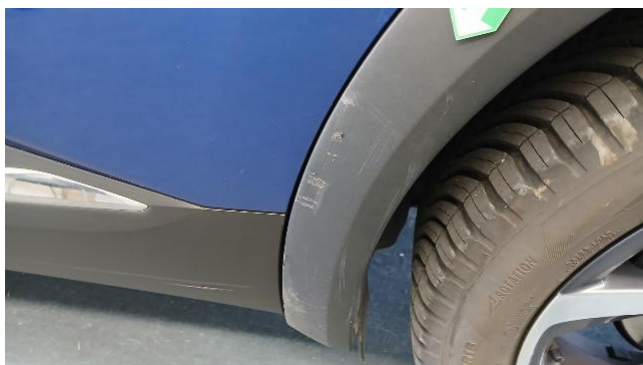
Extension d'aile ARG - Enfoncé - Remplacement
