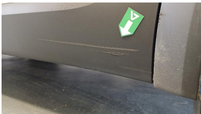
Baguette de porte ARG - Enfoncé - Redressé
