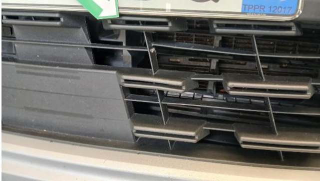
Grille de pare-chocs AV - Cassé - Remplacement
