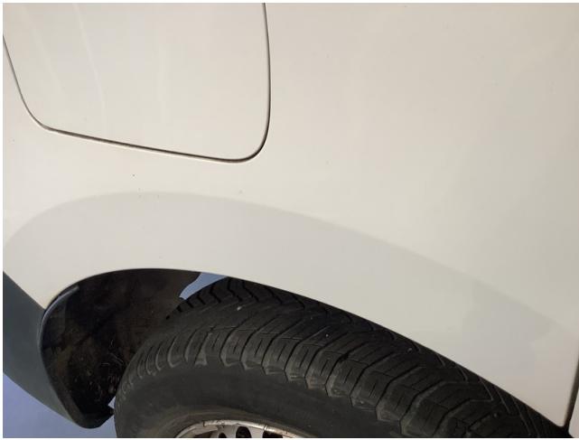
Panneau ARD - Enfoncé - Debosselage (Smart Repair)
